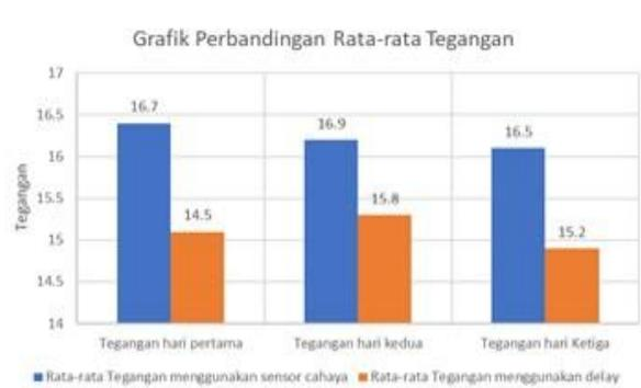
**Gambar 8** Grafik perbandingan Tegangan Keseluruhan selama Pengujian solar tracker 2 sistem ini
